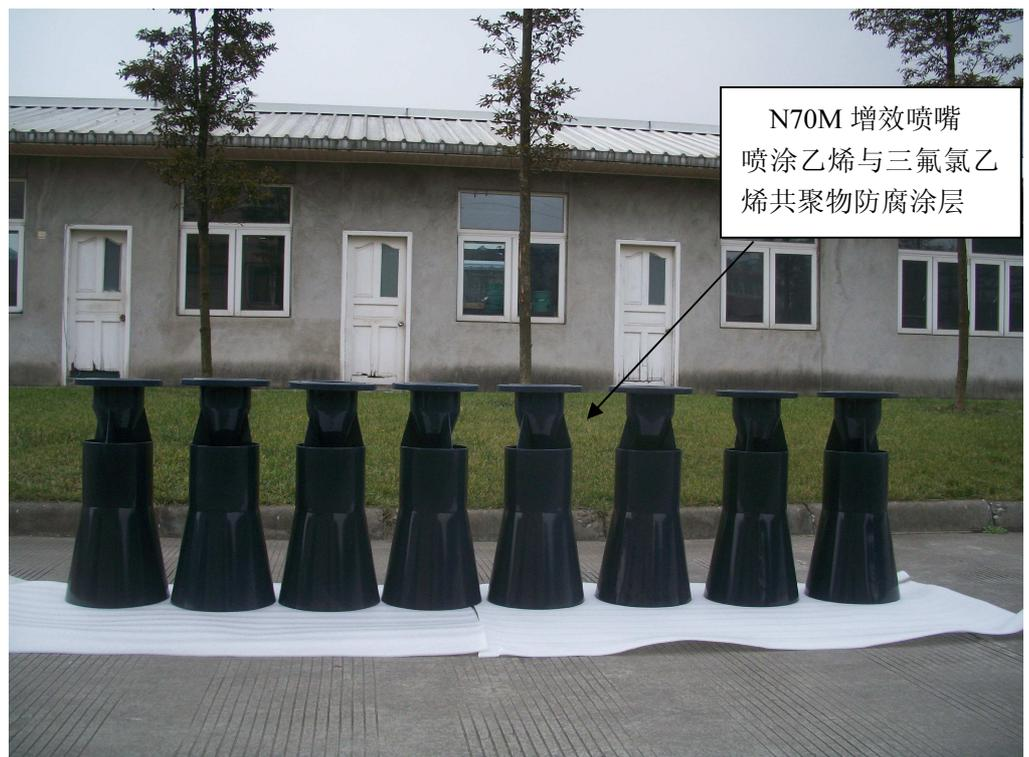
该涂层我们采用的是乙烯与三氟氯乙烯的共聚物，具有热稳定性、耐化学品腐蚀性（耐酸、大多数强碱、强氧化剂及其他化学品；对一些无机盐包括水和盐溶液具有优良的稳定性）和低渗透性能等。
