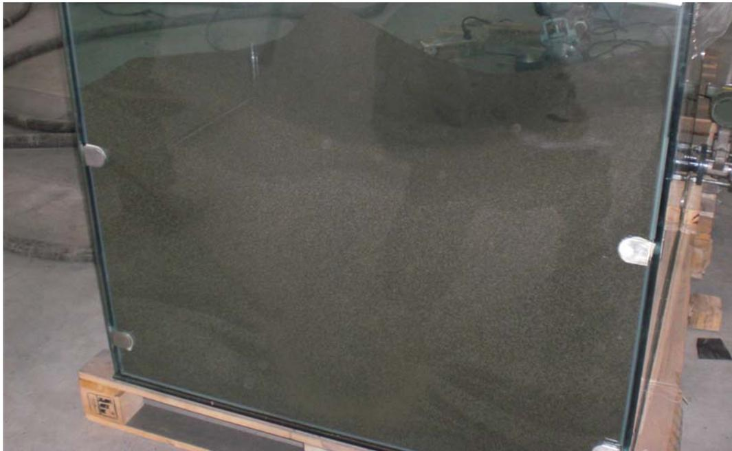
图4 500mm厚0.4MPa压力颗粒运动痕迹
